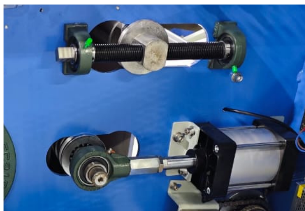
Detalle del conjunto mecánico lateral del sistema de fieltro.
